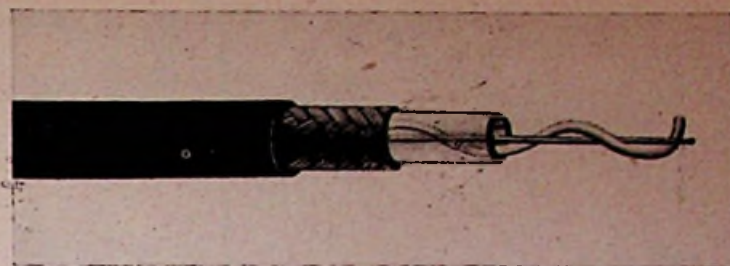
Coax. cable met lucht-isolatie typen RG - 62/U en RG - 63/U, imped. resp. 93 en 125 Ω, demping bij 100 MHz resp. 10,2 en 6,6 dB/100 m.
